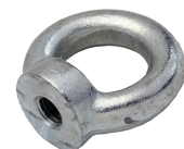
DIN 582 Øjebolt, hun Størrelse: M8 - M36 Materiale: Stål, elforzinket, rustfast A2, A4
