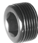
DIN 906 Bundprop m/ indv. 6-kant Størrelse: M8x1 - M42x1,5 (fin-gevind), R1/8" - R2" Materiale: Stål, forzinket, rustfast A4* * = ikke i alle størrelser
