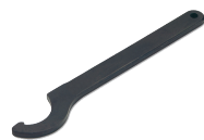
DIN 1810 Nøgle f. hagemøtrik Størrelse: for M8x1 - M60x1,5 Materiale: Stål
