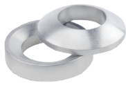
DIN 6319 Kugle- & kegleskrive Størrelse: for M6 - M48 Materiale: Stål, hærdeet eller rustfast A2
