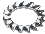
DIN 6798A Stjerneskrive m/udv. forfanding Størrelse: \varnothing 2,2 - \varnothing 31 Materiale: Stål, forzinket, rustfast 1.4310*, A4*, bronze* * = ikke i alle størrelser
